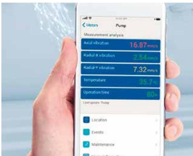
Desarrollado para los motores WEG en las carcasas de tamaño 63 a 450, después de una fácil instalación en el motor, el WEG Motor Scan debe ser configurado a través de un dispositivo inteligente (App disponible para Android e iOS). Después de parado, el sensor envía los datos a la nube vía Bluetooth® y permite el análisis de los resultados en la WEG IoT Platform.
